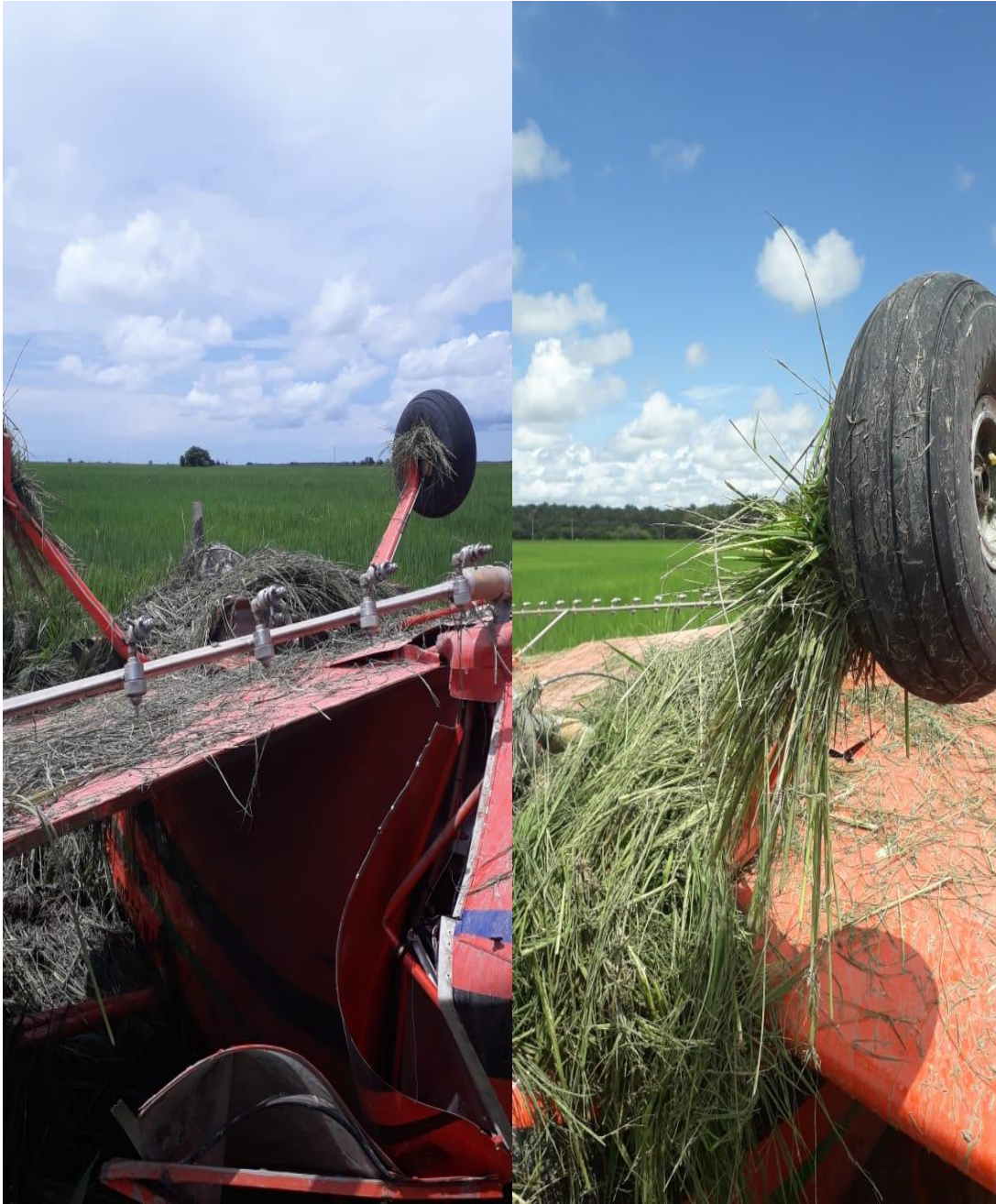
Fotografía No. 2: Vegetación arrancada por el tren de aterrizaje
